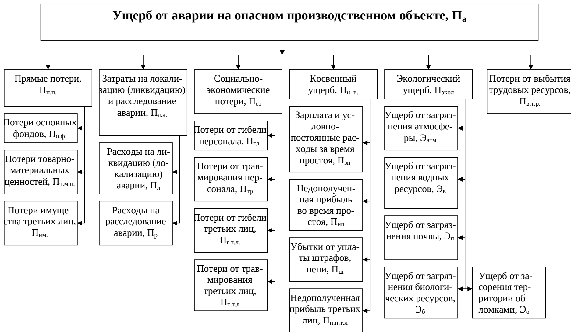
Рисунок 1. Структура ущерба от аварии на опасных производственных объектах
